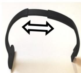
Sie können die Maus Quha Zono X entweder vor oder nach dem Platzieren des Kopfbandes auf Ihrem Kopf mit der magnetischen Halterung verbinden. Sie können die Maus entweder vor oder nach deren Befestigung an der Halterung einschalten – je nachdem, was komfortabler für Sie ist.
