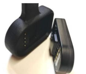
Für die Befestigung der Maus Quha Zono X an der magnetischen Halterung, führen Sie sie nahe an die Halterung. Die Magnete werden sie erfassen und automatisch korrekt positionieren. Die
